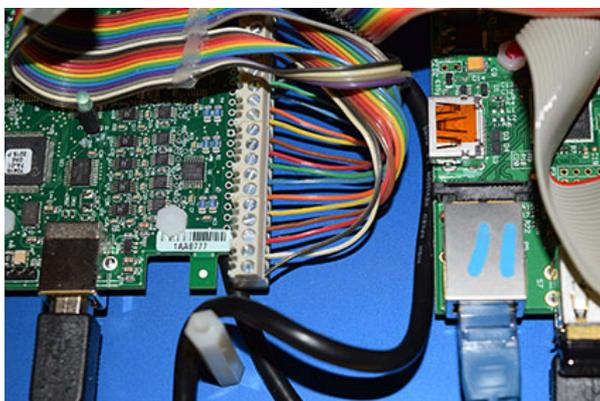
➤ 连接至树莓派 B 型的 USB-1608FS-Plus 同步采集 DAQ 设备
